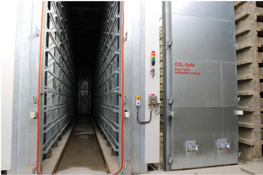
*Die Co2-Kammer ist das pulsierende Herz unserer Carbstone-Produktion. Hier werden die Blöcke mit CO2 gebunden, um dann auszuhärten. Nach 24 Stunden - abhängig von der Größe - sind sie fertig zur Verarbeitung.*
